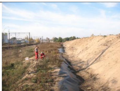
Ryc. 259. Pobór próbek wody do badań z piezometry P3 przy przyźnie bioremediacyjnej.
