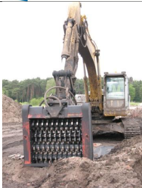
Ryc. 107. Łyżka siejąco-krusząca była niezbędna w pierwszej fazie prac, gdy do płukania trafiały grunty z dużą ilością drobnego gruzu ze starych hałd.
