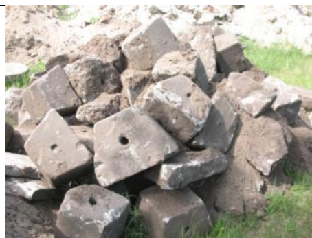
Ryc. 201. Zbierane koparką trapezy (każdy bloczek betonu waży kilkadziesiąt kilogramów) stanowiły dobry, czysty materiał do recyklingu (jako przekrusz betonowy do wielu zastosowań).
