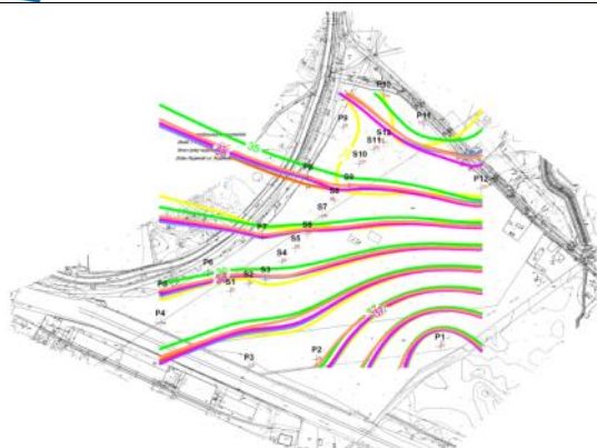
Ryc. 276. Hydroizohipsy z początkowego okresu pomiarów IX2013 – II2014 i skromniejszej sieci otworów.
