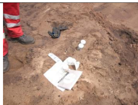
Ryc. 262. Z dna wyrobiska pod halą nasycień pobierane są próbki gruntu do zbadania potencjalnie najsilniejszych skażeń gruntu.
