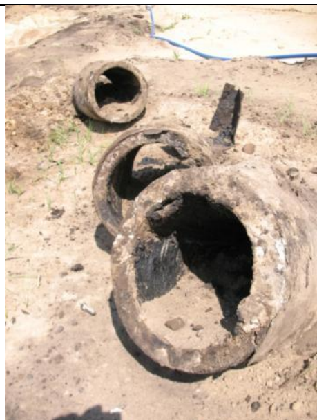
Ryc. 214. Wyjęta część prefabrykowanych, betonowych rur – były one owinięte papą, a na złączach dodatkowo blachą. To jednak nie chroniło przed wyciekami do gruntu ciekłych frakcji oleju impregnacyjnego, który wtedy płynął.
