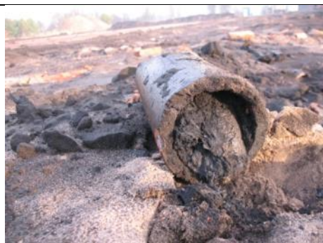
Ryc. 218. W centralnej części terenu niemal każda rura starej kanalizacji zapchana była oleistym szlamem lub wręcz gęstym kreozonego
