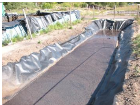
Ryc. 144. Wydłużony osadnik na emulsję olejowo-wodną przy tzw. starym zbiorniku do prania gruntu.
