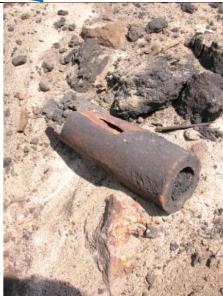
Ryc. 217. W niektórych częściach terenu spotykane były też typowe, ceramiczne rurki drenarskie, ale wypełnione mazią ze zgęstniałego kreozonego.
