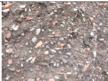
Ryc. 102. Frakcja piaszczysto-żwirowa, czyli skażona ziemia z drobnym gruzem i cząstkami drewna, to najtrudniejszy materiał do procesu prania.
