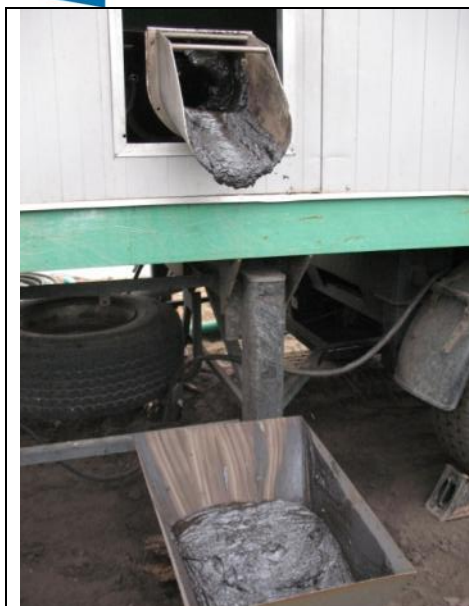
Ryc. 188. Wykonawca rekultywacji wobec wytwarzanych w procesie oczyszczania odpadów niebezpiecznych podejmował szereg prób zmniejszenia uciążliwości dla środowiska, ich objętości i uwodnienia oraz ewentualnych kosztów unieszkodliwiania. Tu: testowanie skuteczności i wydajności prasy odciskającej wodę ze szlamów zgromadzonych w osadnikach.
