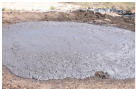
Ryc. 184. Gęsta i mazista postać szlamów dennych bardzo przypominała pastę kreozotową. Jednak znacznie szybciej traciła zawartą wodę i wysychając pękała w charakterystyczny sposób.
