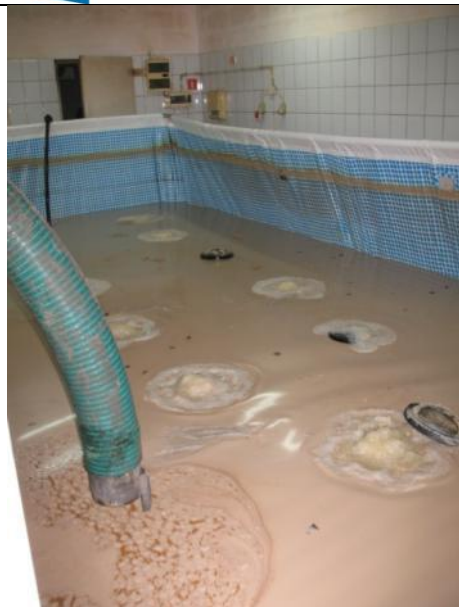
Ryc. 152. Zimą 2013/2014 produkcję biopreparatu prowadzono w warunkach „cieplarnianych” w wynajętej hali w Solcu Kujawskim i dowożono na teren beczkowozem, by dokonać aplikacji mikroorganizmów na poletka remediacyjne. Na zdjęciu faza opróżniania basenu hodowlanego do beczkowozu.
