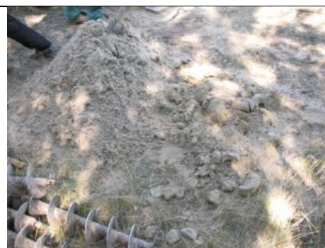
Ryc. 13. Piaski wydobywane w czasie wiercenia otworów pod piezometry w części południowej nie nosiły żadnych znamion zanieczyszczenia półproduktami lub odpadami z nasycalni.
