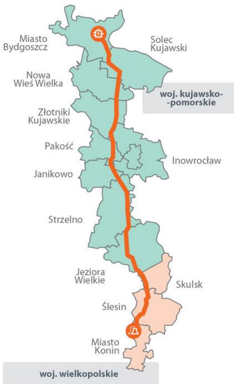
Rysunek 4.4-1.Przebieg projektowanej linii 400 kV
