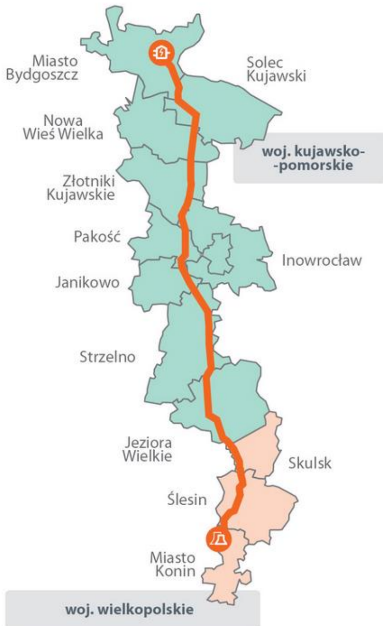
Rysunek 4.4-1.Przebieg projektowanej linii 400 kV
